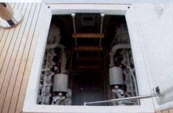
La sala macchine ospita due Man turbo diesel common rail da 1100 o 1224 cv.
