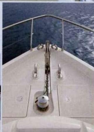
*Sopra, l'area tecnica di prua è pratica, ma occorre prestare attenzione alle galloce ai lati della catena. Sotto, il posto di guida del fly con plancia a scomparsa.*
